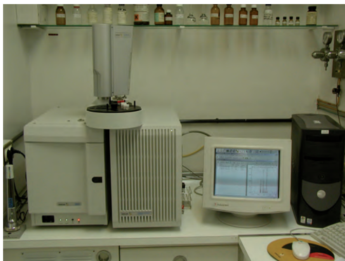
FIGURA 5.5. Cromatògraf de gasos acoblat a un detector de masses. Viader Anàlisis, Sant Sadurní d'Anoia, 2003.
