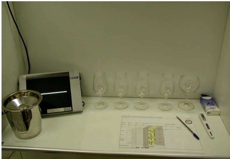
FIGURA 11.1. Cabina de tast amb els elements necessaris: escopidora, Enoscope, copes ISO de tast, copa d'aigua, tovallons de paper, termòmetre, bolígraf i fitxa de tast. Laboratoris Viader Anàlisis, SL.
